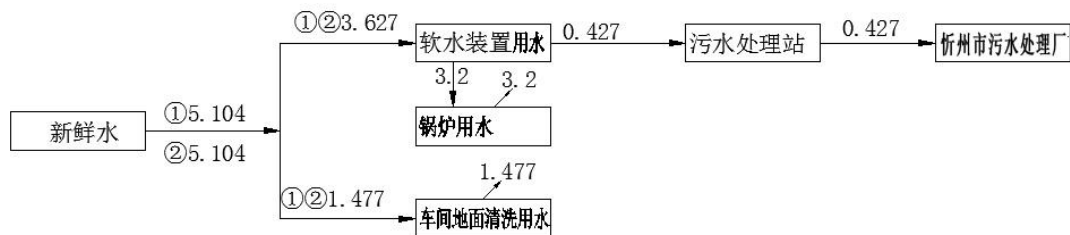
图 1 本次项目水平衡图 (m 3 /d) (①非采暖期②采暖期)
